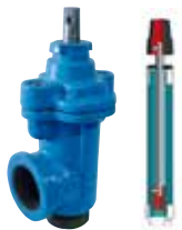
19 Válvula de escuadra uniones roscadas. DN20-50 (3/4"-2")
